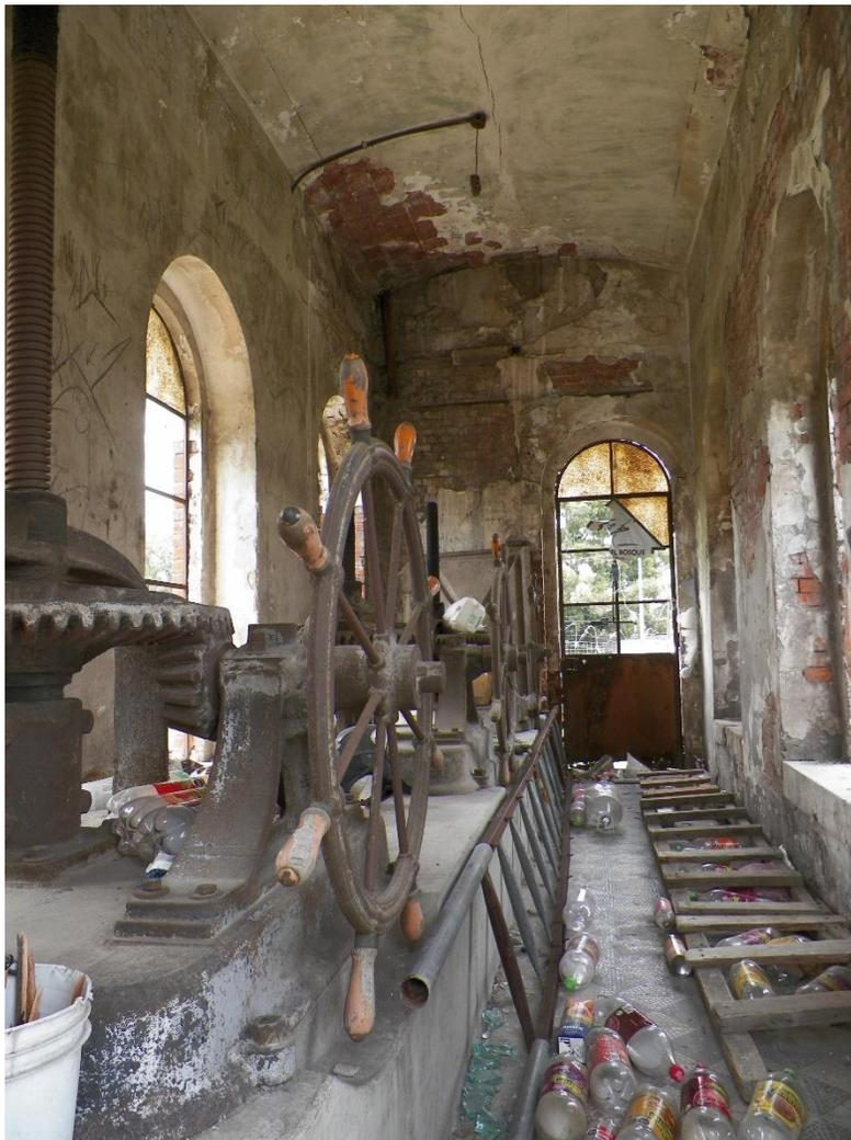
Foto 12. En el interior del cuarto de máquinas, se observan tres mecanismos de manivelas, ejes y engranes para abrir y cerrar las tres compuertas (Fotografía Guillermo Escobar, 2021).
